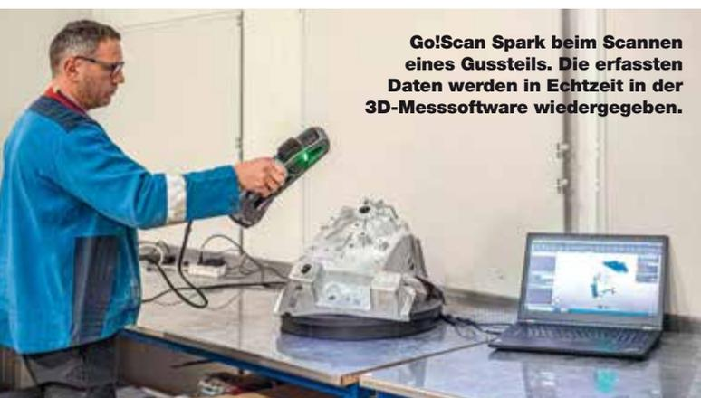
Go!Scan Spark beim Scannen eines Gussteils. Die erfassten Daten werden in Echtzeit in der 3D-Messsoftware wiedergegeben.
