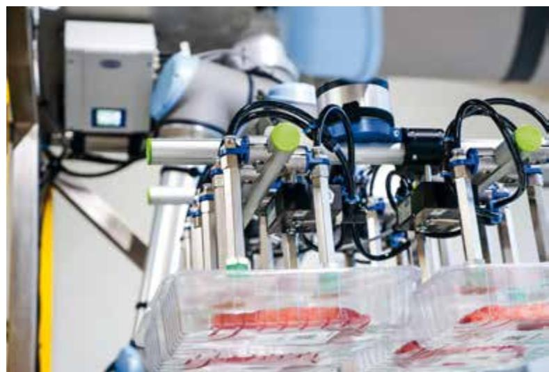
**Die Compact Pump GCPI (oben links) stellt das benötigte Vakuum rein elektrisch zur Verfügung.**
