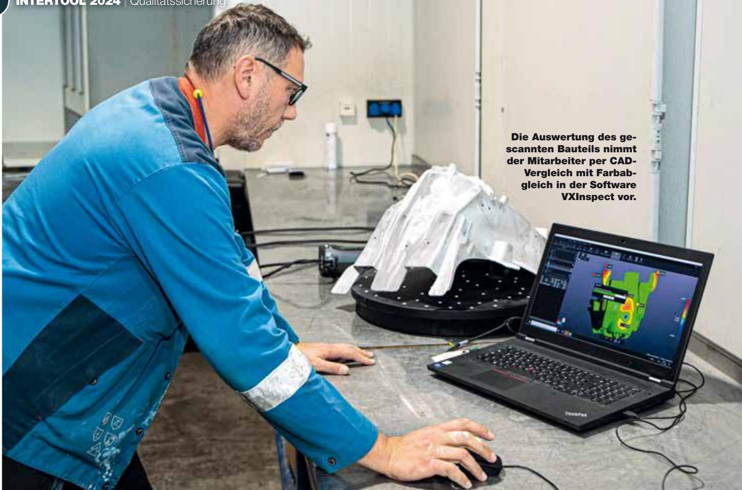
Die Auswertung des gescannten Bauteils nimmt der Mitarbeiter per CAD-Vergleich mit Farbabgleich in der Software VXInspect vor.
