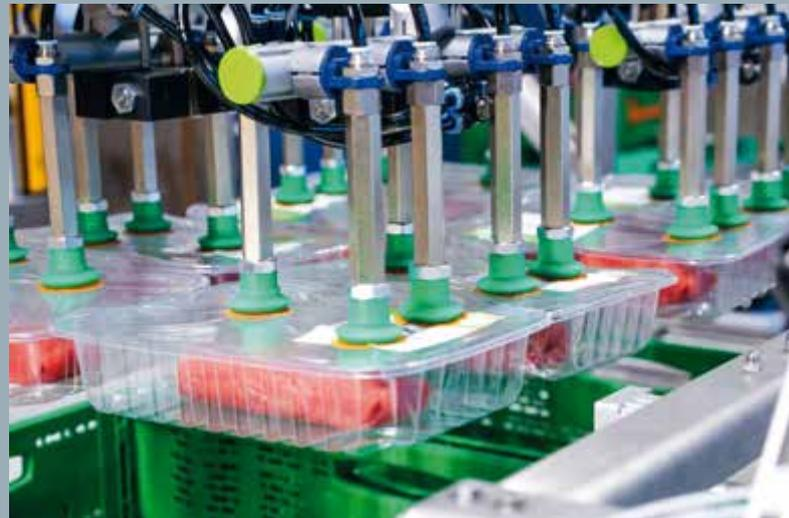
**Die Balgsauggreifer PSPF picken selbst unregelmäßig geformte Oberflächen und legen sie zuverlässig am Zielort ab.**
