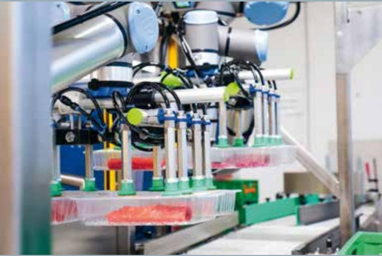
**Die automatische Greiferlösung schafft 96 Picks pro Minute – dadurch erhöhte der Fleischverarbeiter seinen Output im Vergleich zur manuellen Tätigkeit deutlich.**
