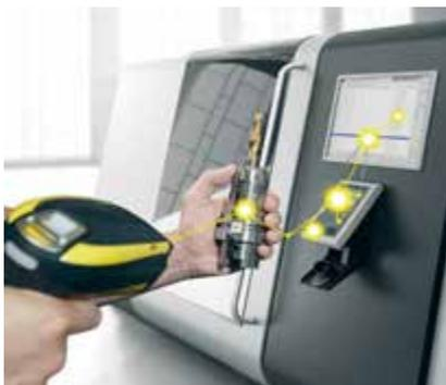
**zidCode 1.0 ist eine einfache und kostengünstige Variante zur Datenübertragung an die Maschinensteuerung mit einem QR-Code-Etikett.**
