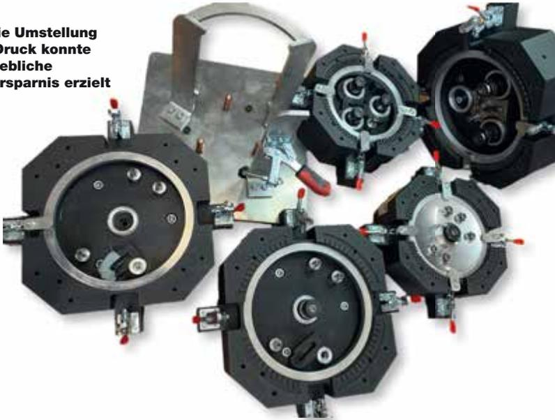
Der Vorteil der Additiven Fertigung ist, dass nun eine Gasführung in die Vorrichtungen integriert werden kann, mit der Formiergas geleitet wird. Formiergas ist für das saubere Schweißen ein wichtiger Faktor. Nun ist es möglich, das Formiergas genau dahin zu leiten wo es hinsoll – mit nur einem Anschluss. So wurde buchstäblich „um die Ecke gebohrt!“
