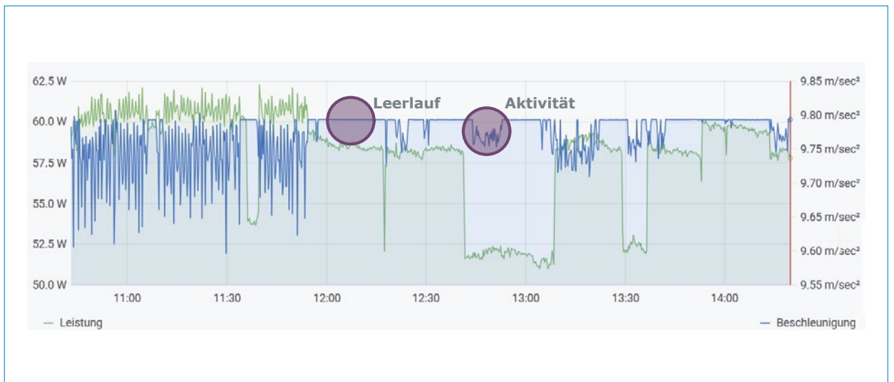
Abbildung 8: Zustandsüberwachung mittels Bewegungserfassung (Ruhewert der Beschleunigung ist die Erdbeschleunigung)
