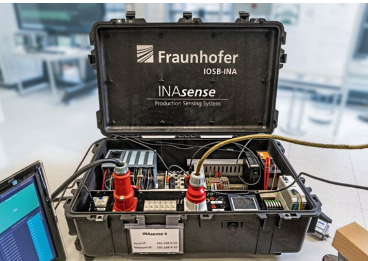
Abbildung 11: Die Leistungsmessung erfolgte über das im INAsense integrierte Leistungsmessgerät
